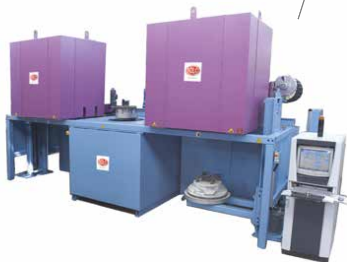
2 fours et 1 bac
