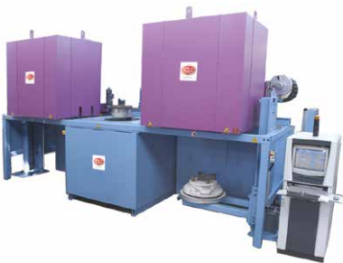
Four de trempe additionnel entièrement équipé
